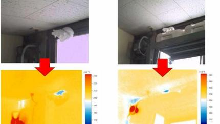
前ページに引き続き、ALC外壁中間目地から (1.2) 付近に30分散水を行いました。散水開始後約20分程度で倉庫内側サッシ廻りから雨漏りが確認されました。天井との取り合い部からも雨漏りが確認されており、中間目地からも滲入していると思われる。次は明らかに経年劣化の症状が見られる部分 (道路面) の目視調査に移ります。
