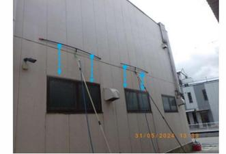
雨漏り調査8箇所目として、今度は倉庫内サッシ上ALC中間目地及びサッシシール部に (5.6) 付近に30分散水を行いました。散水開始後約12分程度で倉庫内側サッシ廻りから雨漏りが確認されました。次ページでご提示します。
